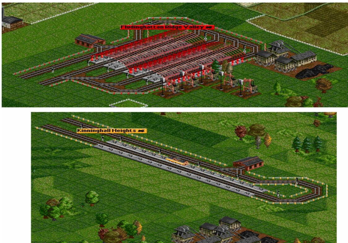
**Figura 8.** A imagem mostra duas estações de tamanho, número de pistas e orientação diferentes criadas usando o algoritmo proposto. Note que os trens sempre chegam por um lado e saem pelo outro. Dessa maneira, evita-se os *deadlocks* e minimiza-se os congestionamentos.
